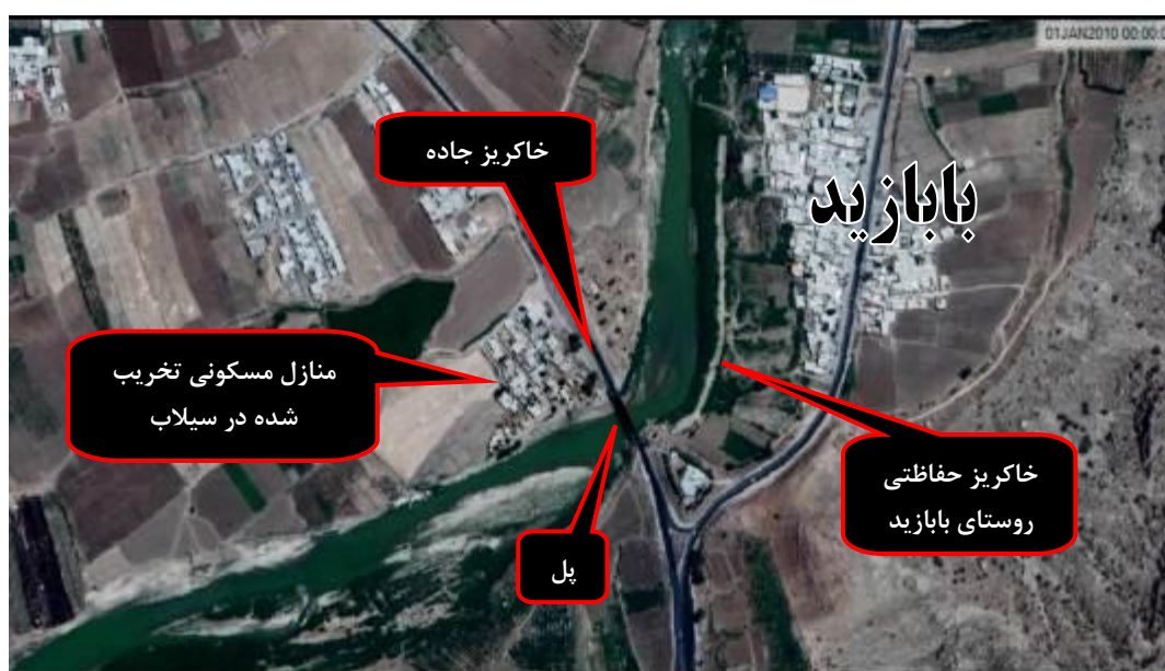
شکل ۹- جزئیات سازه ها و عوامل تشدید خطر سیلاب
