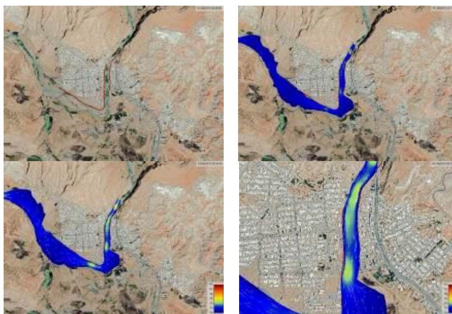
شکل ۱۱- کنترل سیلاب توسط دیواره حفاظتی در دو سمت رودخانه کشکان در محدوده شهر پلدختر
